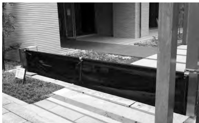
会 員 名：大同機工 (株) 製 品 名：シート式防水扉 製 品 特 徴：防水シート両端の水密ファスナーを引き上げるだけで設置完了。また、底部収納なので、防水板の収納場所や移動はありません。
