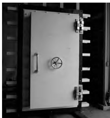
会 員 名：田中サッシュ工業 (株) 製 品 名：片開き防水扉 製 品 特 徴：ハンドルを回転させることで扉と枠を密着させます。ラック式グレモンにより軽い操作で止水状態にすることができます。
