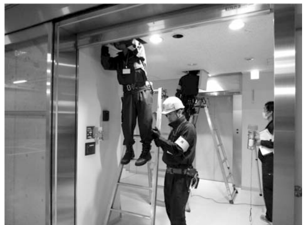
運動エネルギーは質量と速度から求めるため、防火シャッターの降下時間を測定中
