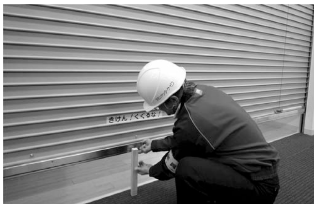
危害防止装置に関する告示では 5cm 以内停止が求められている
