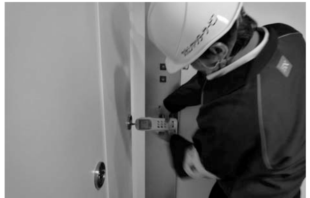
防火戸の閉じ力をテンションゲージで測定中
