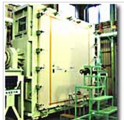
潜り戸付片開き防火戸の開閉確認試験
