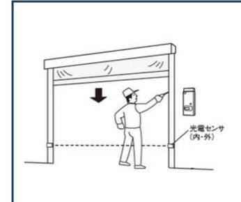
障害物感知用光電センサが付いておりますが、下記のような場合には検知できず高速シートシャッターが閉鎖することがありますので、高速シートシャッターの下で作業をしたり、立ち止まったりしないでください。
